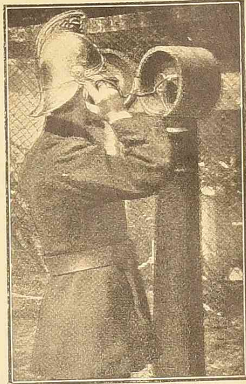
Переносный телефонъ, для лондонскихъ пожарныхъ, приспособляемыхъ къ уличнымъ сигнальнымъ аппаратамъ.
